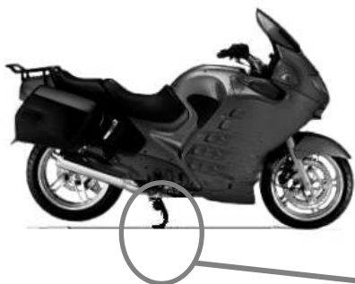
Moto en stationnement sur sa béquille électrique centrale.
