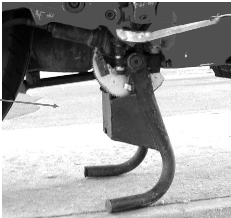
Moto en stationnement sur sa béquille électrique centrale.
